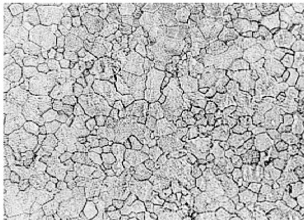
Figura 1 – Micrografia óptica do Ti grau 2 (aumento 200×).
